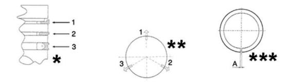
\* Fit piston rings «2» and «3» with the mark «TOP» facing up.
